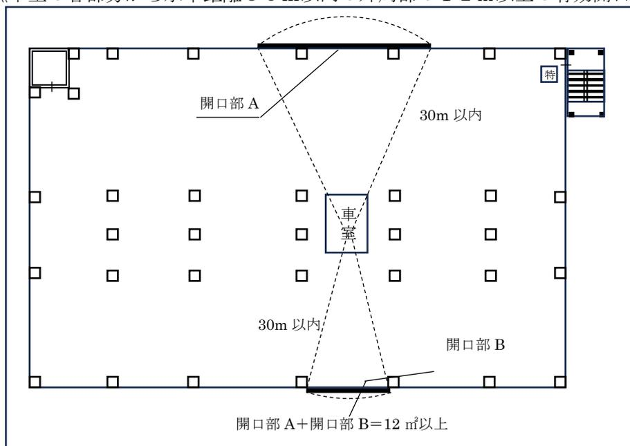
《車室の各部分から水平距離30m以内の外周部の12㎡以上の有効開口部の例》
